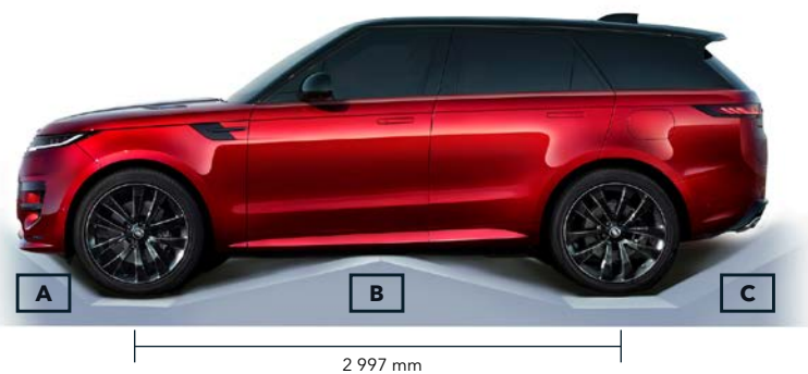
Läbimurdenurk A Töönurgad 33,0° / 30,0° B Lähenemisnurk 26,09° C Väljumisnurk 30,0°
